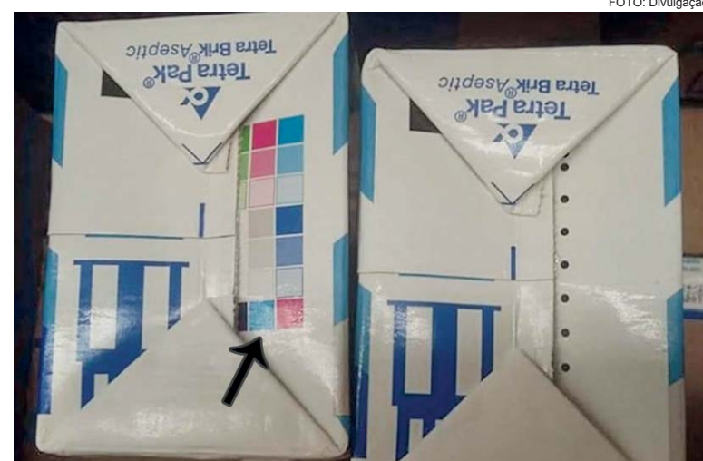
As barras coloridas fazem parte de uma das etapas do processo de impressão. Elas ajudam a assegurar que as cores estampadas nas embalagens estejam na tonalidade adequada e ocupando os espaços corretos, segundo a Tetra Pak
